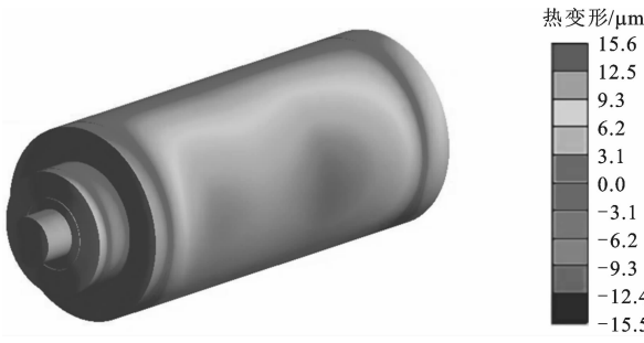
图 11 电主轴径向热变形
